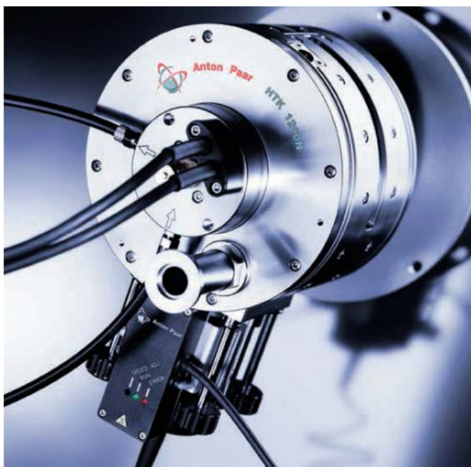
Рис. 3.30 – Фотография высокотемпературной камеры для порошкового дифрактометра.
