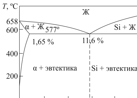
Рис. 1.7. Диаграмма состояния сплавов системы Al–Si, %
