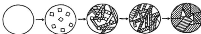
Схема кристаллизации стекла при образовании ситаллов с помощью нуклеаторов
